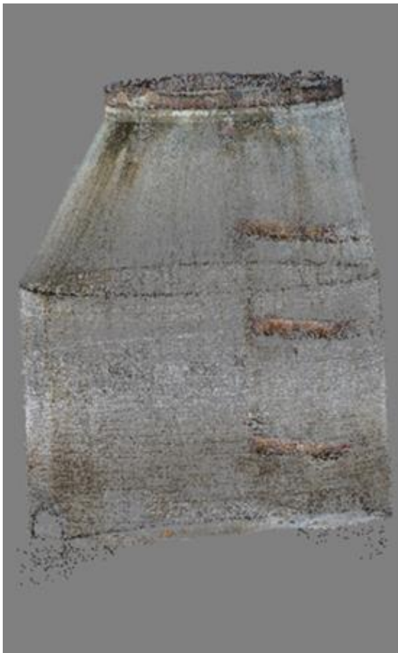
写真4 マンホール内部の点群データ
